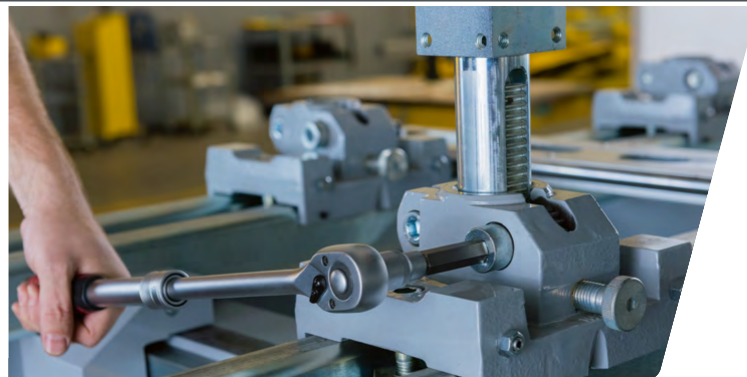
Système de crémaillère pour la poussée vers le haut ou le tirage vers le bas, directement à partir du gabarit.
