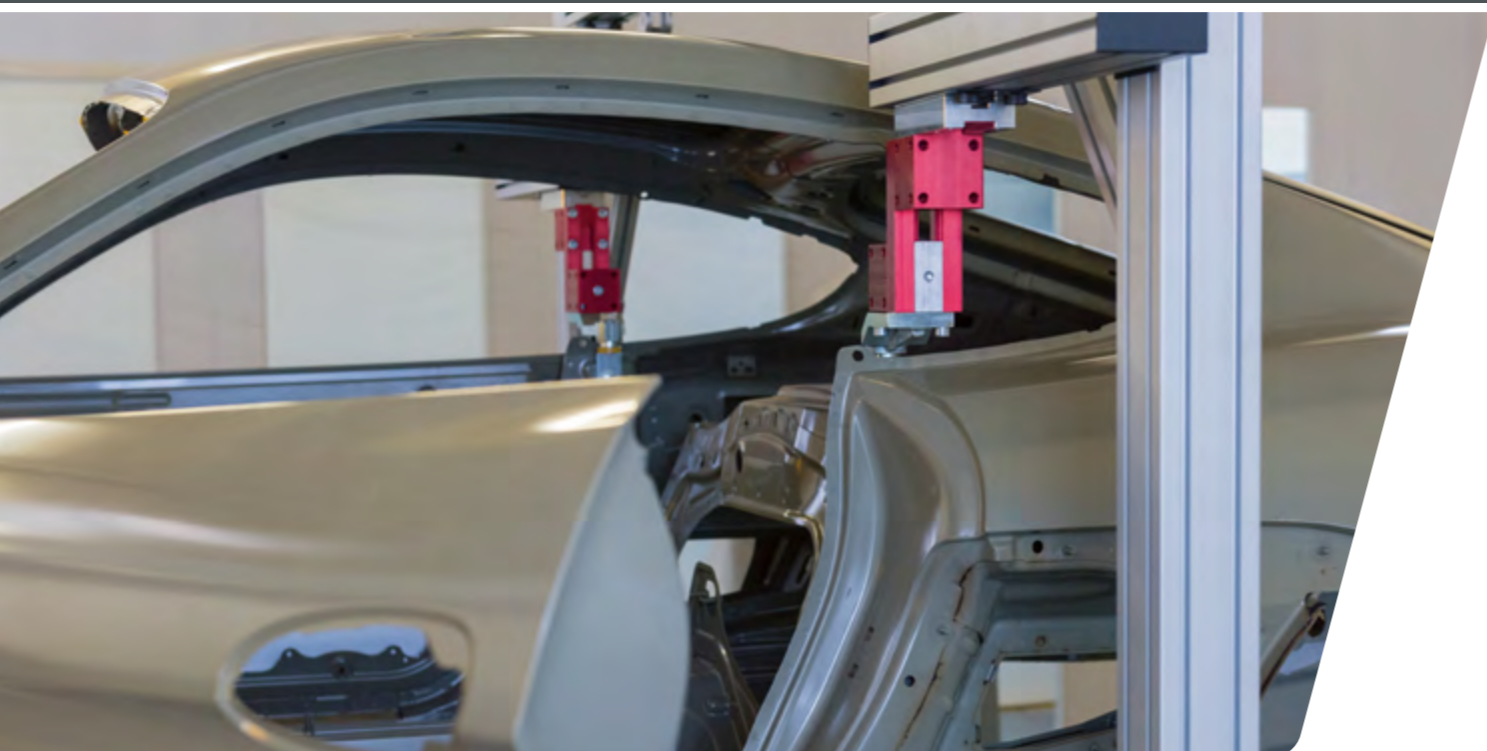
Système de superstructure utilisé pour soutenir les pièces externes et contrôler les portières.
