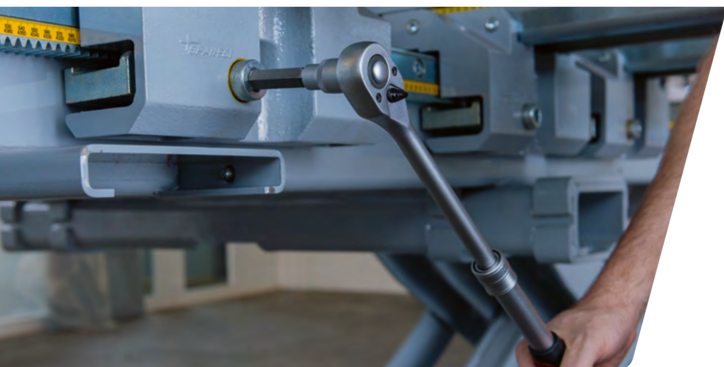
Glissement longitudinal de la barre transversale sur les bancs de redressement, pour positionner facilement le véhicule sur le banc.
