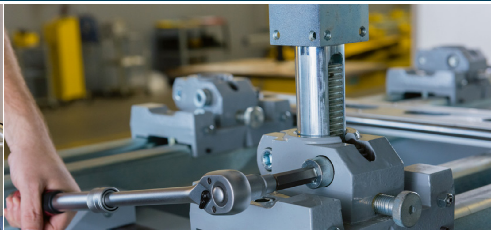
Originale sistema di ingranaggio a cremagliera per spinte verso l'alto e tiri verso il basso, direttamente dalla dima.
