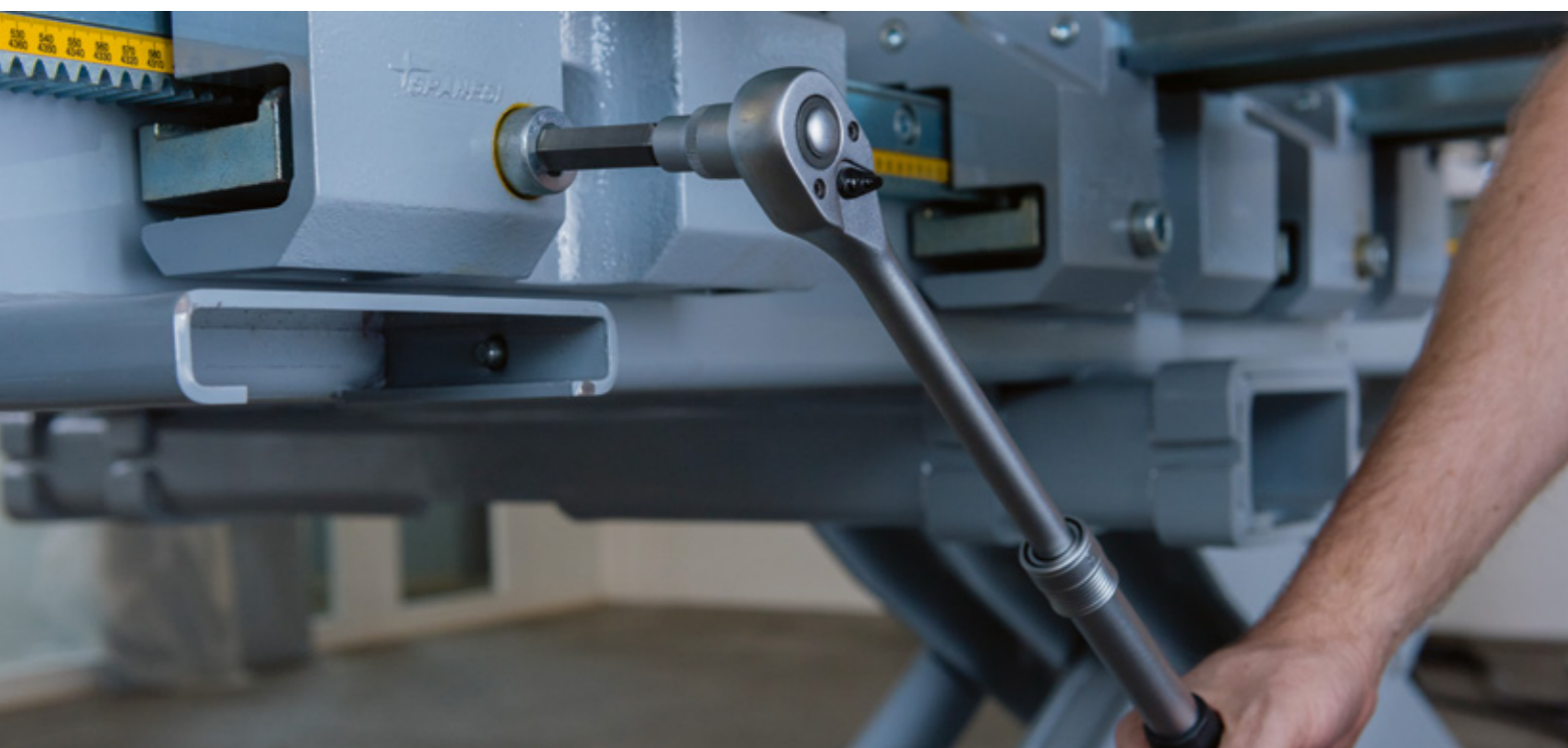
Scorrimento longitudinale della traversa dima su cremagliera.
