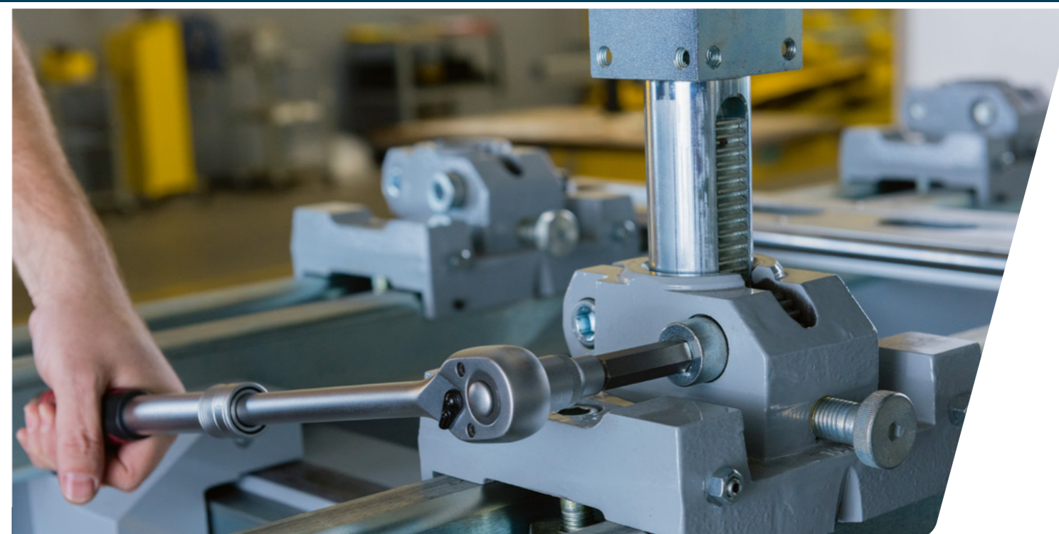
Originale sistema di ingranaggio a cremagliera per spinte verso l'alto e tiri verso il basso, direttamente dalla dima.
