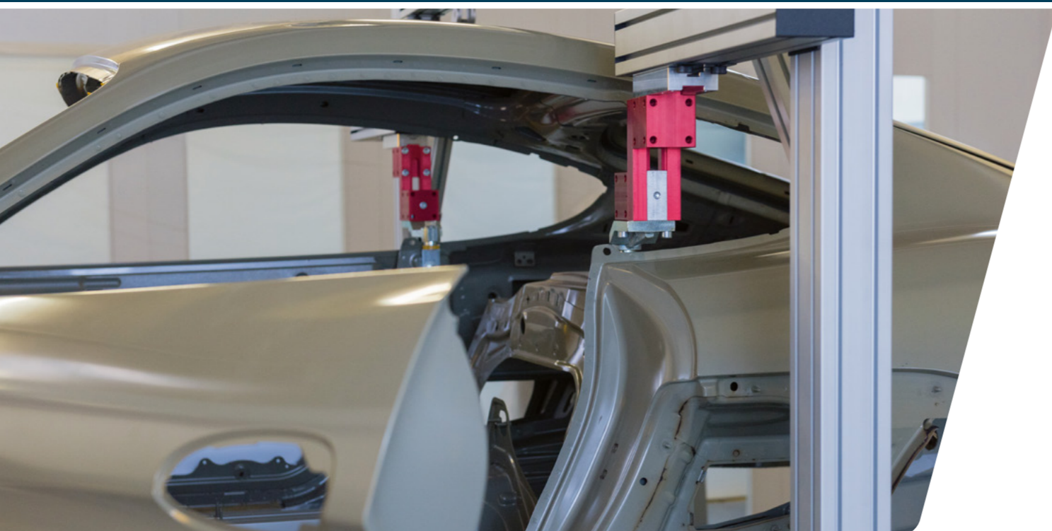
Sistema Upper body per il supporto delle parti esterne e controllo della porta.
