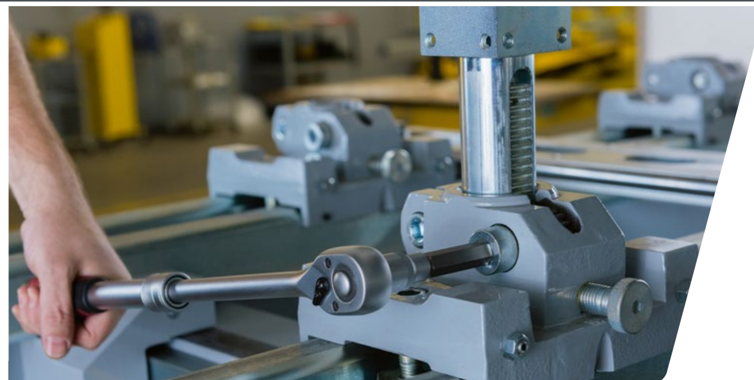
Gestell zum Auf- und Abbewegen direkt an der Richtbank.
