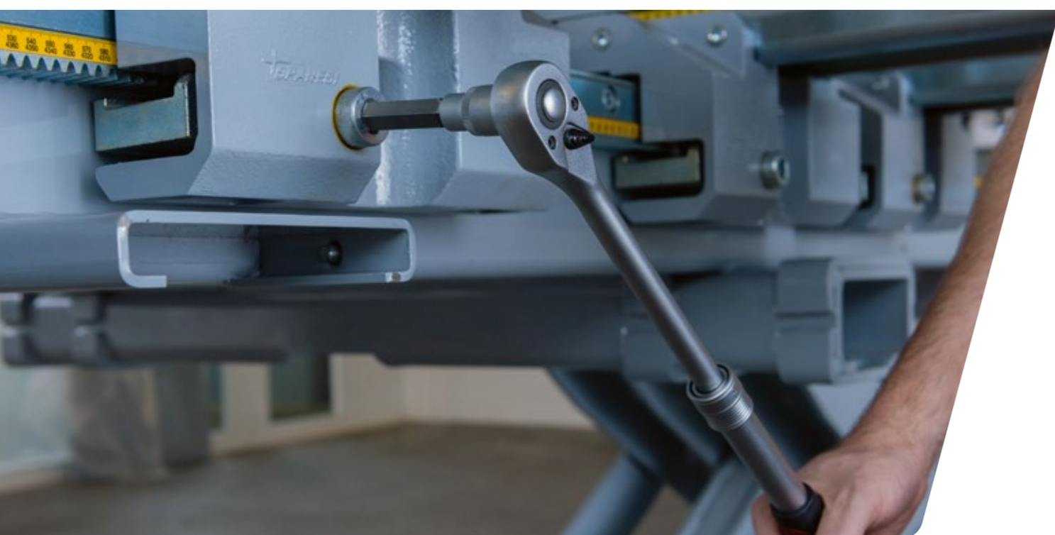
Längsverschiebung der Einspannquerstrebe auf Richtbänken, um das Fahrzeug leicht auf der Bank zu positionieren.
