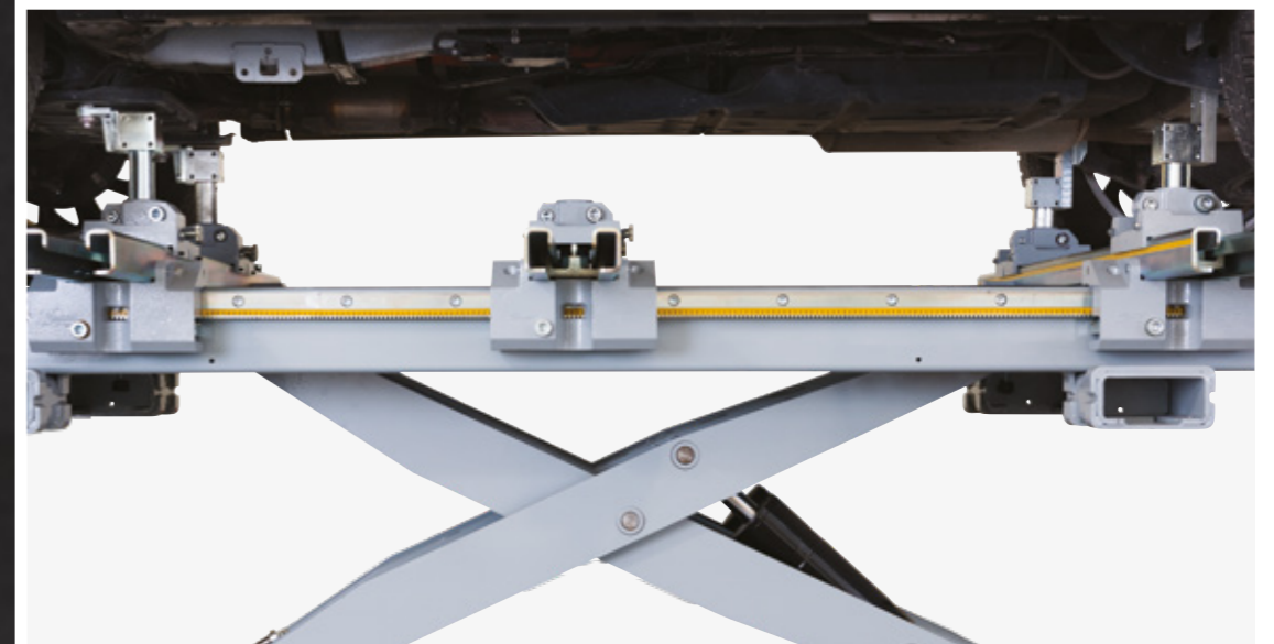
Präzise Montage und Halterung mit Universalrichtsatz
