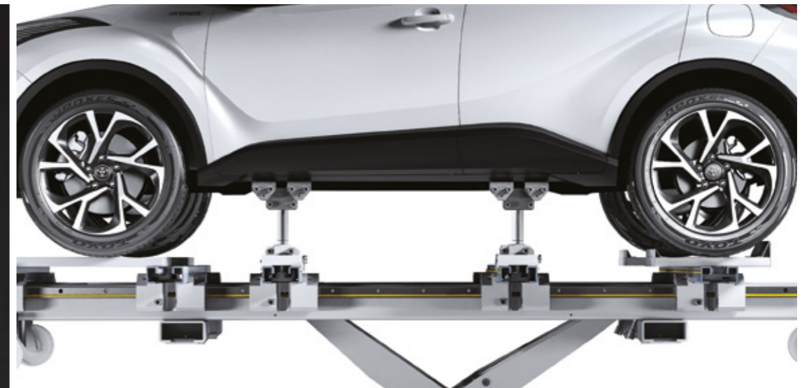
Einfache Montage und Halterung mit Universalklemmen
