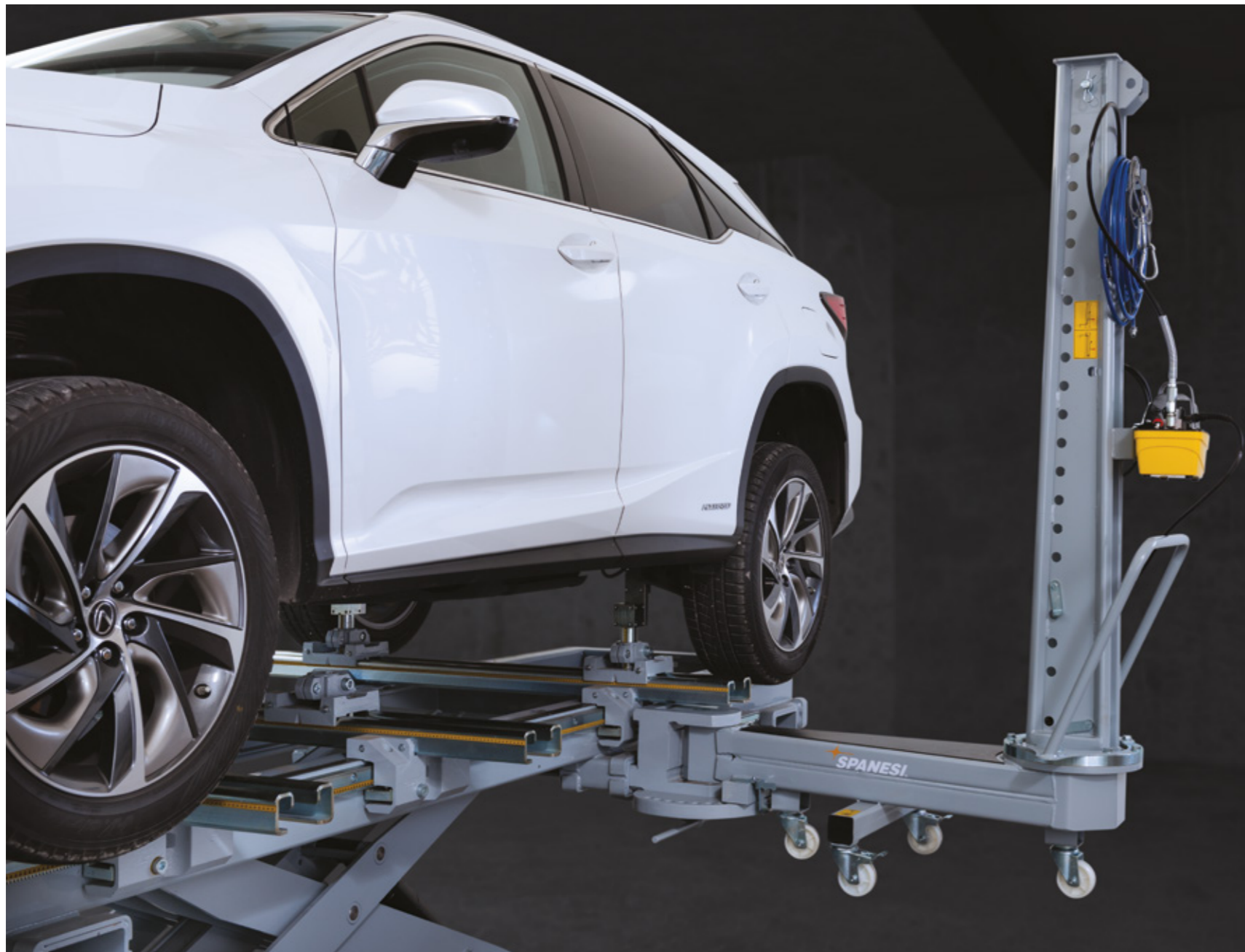
Einfache Montage und Halterung mit Universalklemmen
